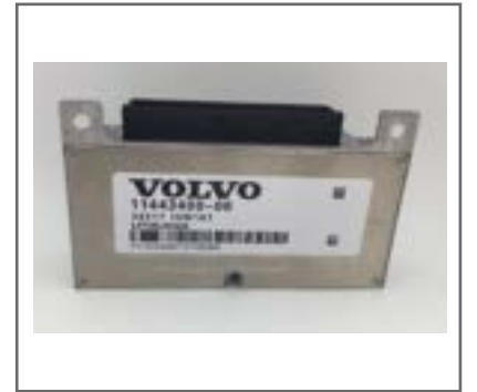
KLİMA KONTROL ÜNİTESİ Air Conditioner Control Unit
